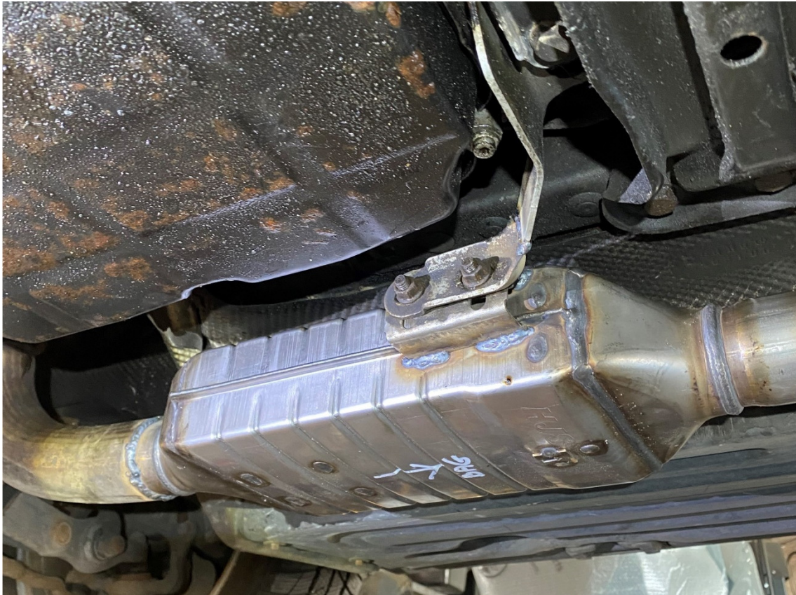
Her er vist tilsvarende eksempel på montering af samme DPF enhed på en MB E270. Montering på højre side af gearkasse, tæt på motoren og katalysator.
